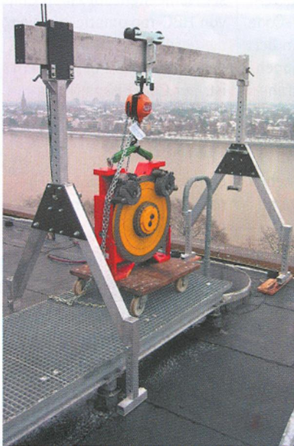
Firma Feltes lässt sich vielfältig einsetzen. Dank seiner Traglast von bis zu 1 500 kg ist der Kran eine gute Hilfe beim Heben und Versetzen diverser Lasten: beim Aus- und Einbau von Motoren und Steuergeräten, bei der War-
