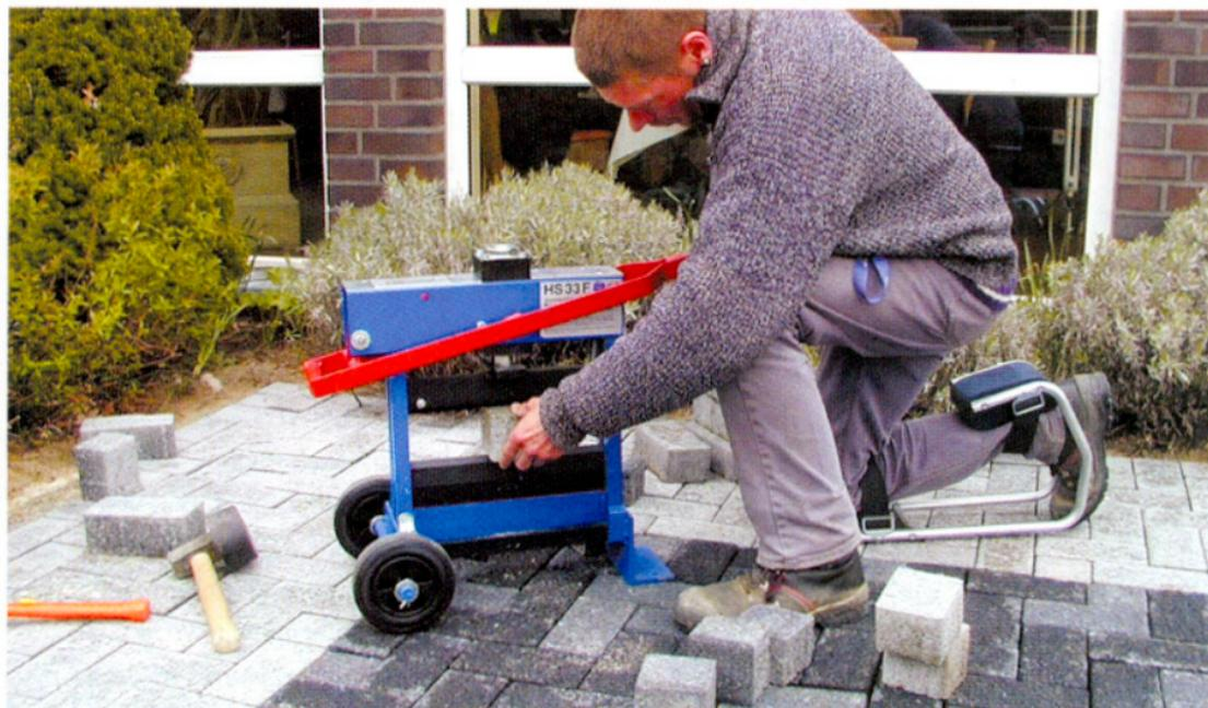
Der HS 33 F ist besonders geeignet zum Spalten von Betonsteinen. | Foto: Feltes.
